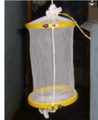
Fig. 3 Ejemplo de jaula centinela construida con tul y dos aros de bordar. Fente: Juan Fernando Ríos.
